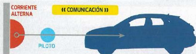
**Modo 2.** Infraestructura de recarga en toma tipo Schuko en pared, con sistema de función piloto incluido en el cable. Es decir que el cable tiene un dispositivo intermedio de control piloto que sirve para verificar la correcta conexión del vehículo a la red.
