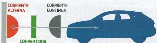
**Modo 4.** Infraestructura de recarga con convertidor a corriente continua. Sólo se aplica a las recargas rápidas.
