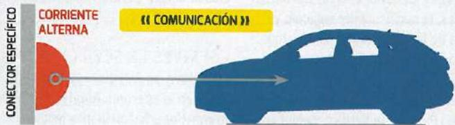
**Modo 3.** Infraestructura de recarga en toma tipo Mennekes con hilo piloto de comunicación integrado. Los dispositivos de control y protecciones se encuentran dentro del propio punto de recarga.
